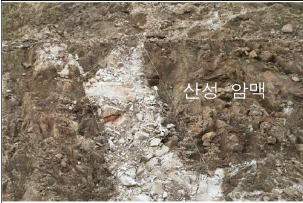
【그림 24】 C 영역 상세사진 (산성암맥관입)
