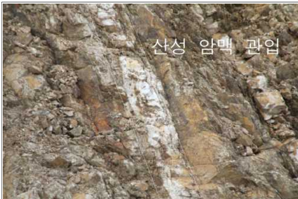
【그림 23】 C 영역 상세사진 (산성암맥 관입)
